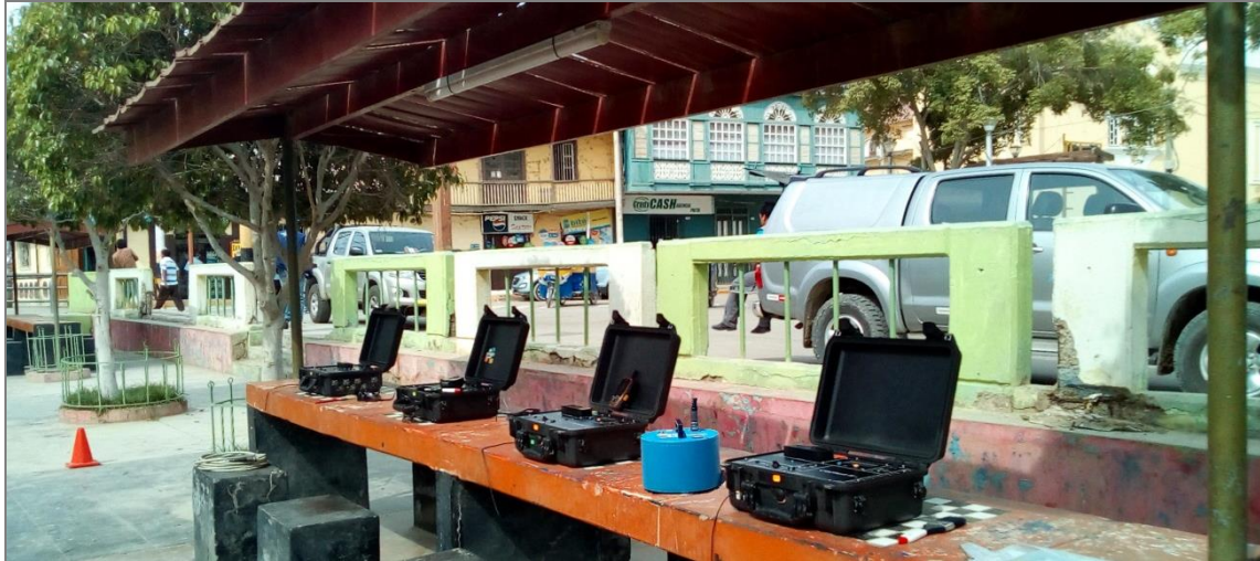
Figura 2: Equipo sísmico utilizado para el registro de vibraciones ambientales en Sullana: sensor Lennartz (2N) y registradores CityShark II.
