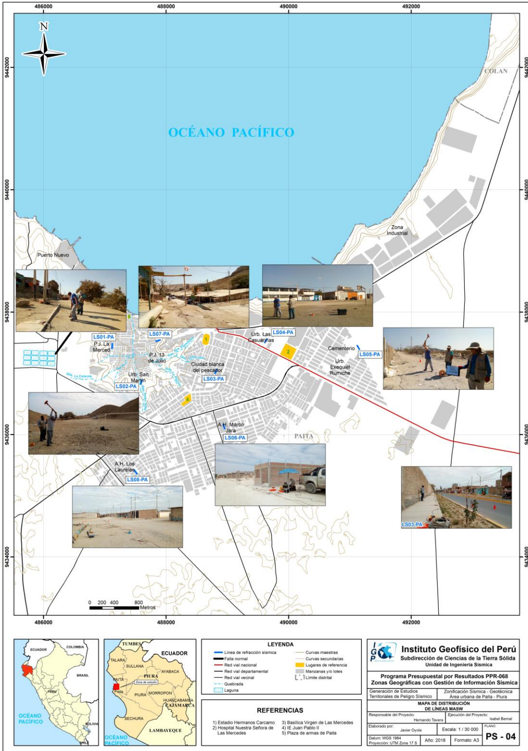
Figura 12: Mapa del área urbana del distrito de Paita y distribución espacial de los arreglos lineales MASW codificadas como: LS01-PA, ..., LS08-PA.
