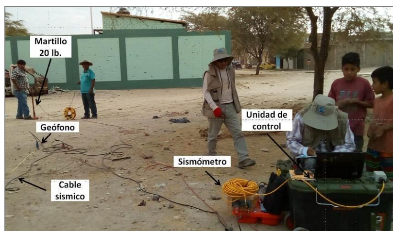
Figura 10: Equipo sísmico para la toma de datos de MASW en el A.H. Los Algarrobos.
