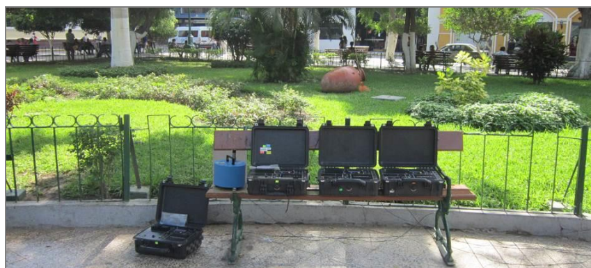
Figura 6: Equipo sísmico utilizado para el registro de vibraciones ambientales en Piura: sensor Lennartz (2N) y registradores CityShark II.
