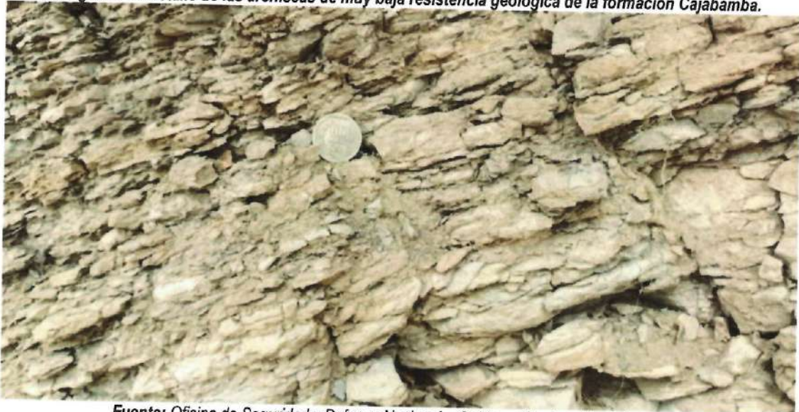
Fotografía 14. Detalle de las areniscas de muy baja resistencia geológica de la formación Cajabamba.
