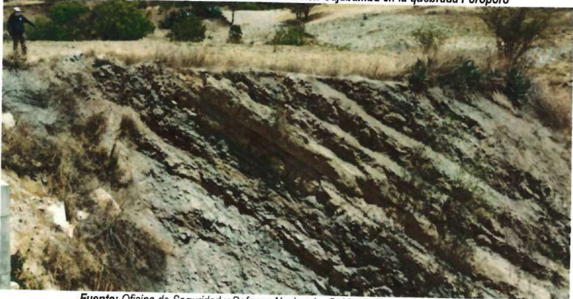
Fotografía 14. Detalle de las areniscas de muy baja resistencia geológica de la formación Cajabamba.
