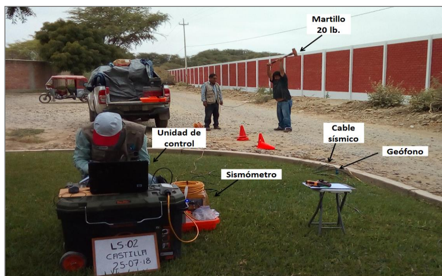
Figura 11: Equipo sísmico para la toma de datos de MASW en el A.H. Los Algarrobos.
