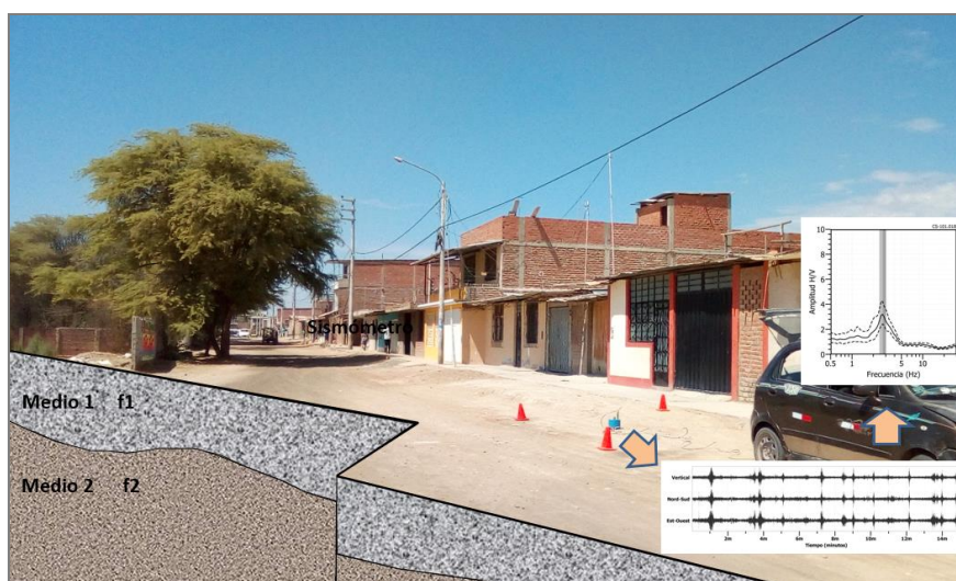
Figura 1: Registro de vibración ambiental.
