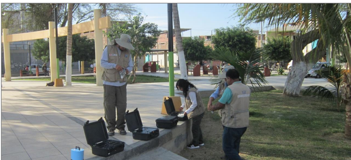
Figura 2: Equipo sísmico utilizado para el registro de vibraciones ambientales en Castilla: sensor Lennartz (2N) y registradores CityShark II.
