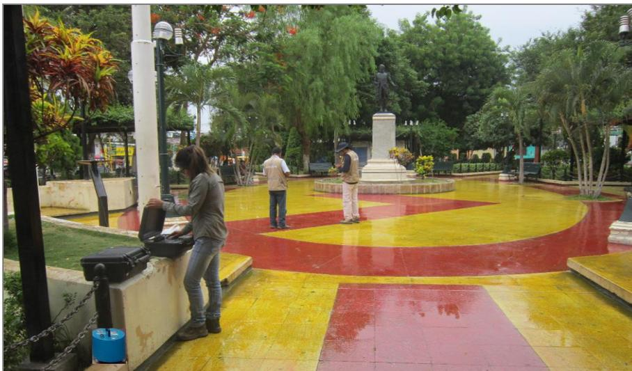
Figura 1: Equipo sísmico utilizado para el registro de vibraciones ambientales en Chulucanas: sensor Lennartz (2N) y registradores CityShark II.
