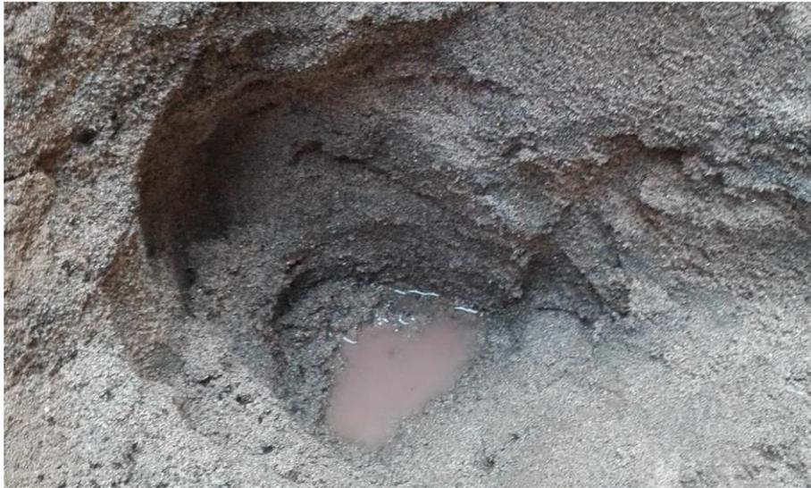
*Figura 21: Capa de áreas gruesas saturadas de hasta 2 m de espesor.*
