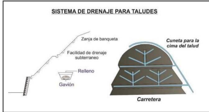
Figura 19 Sistema de drenaje tipo espina de pez.
