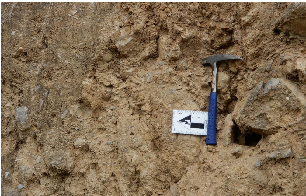
Fotografía 2. Clastos angulosos de calizas envuelto en una matriz de limo arenas, ubicado con coordenadas UTM WGS-84, Este: 789717 y Norte: 9363100.
