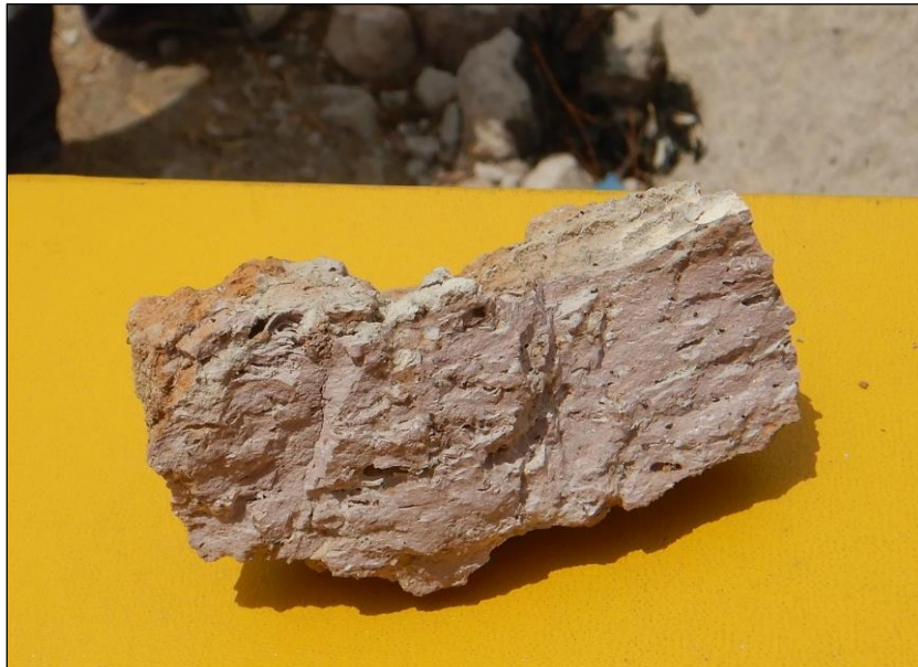
Fotografía 1. Vista de muestra de mano, se puede observar una toba volcánica del Grupo Nasca.
