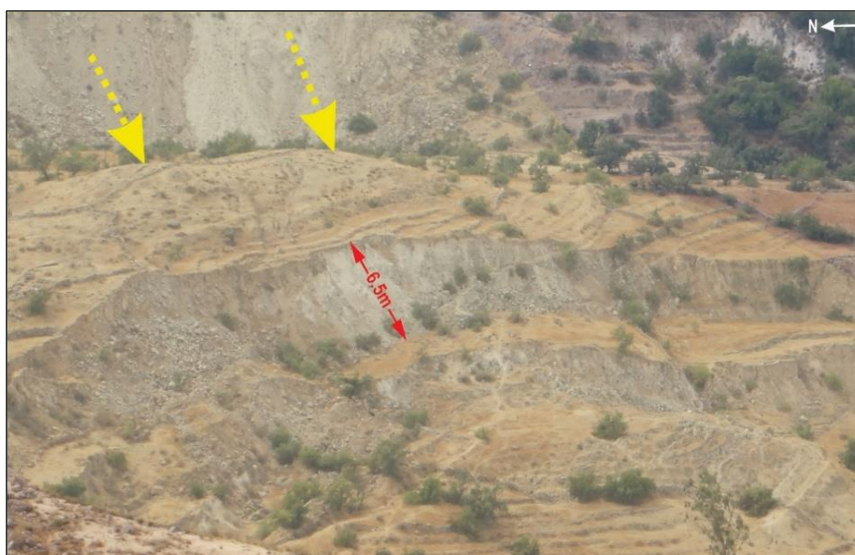
Figura 16. Vista del deslizamiento donde se puede observar saltos de hasta 6.5m, ubicadas en las siguientes coordenadas UTM 8362505 N, 537833 E con una altitud de 2555 m s.n.m
