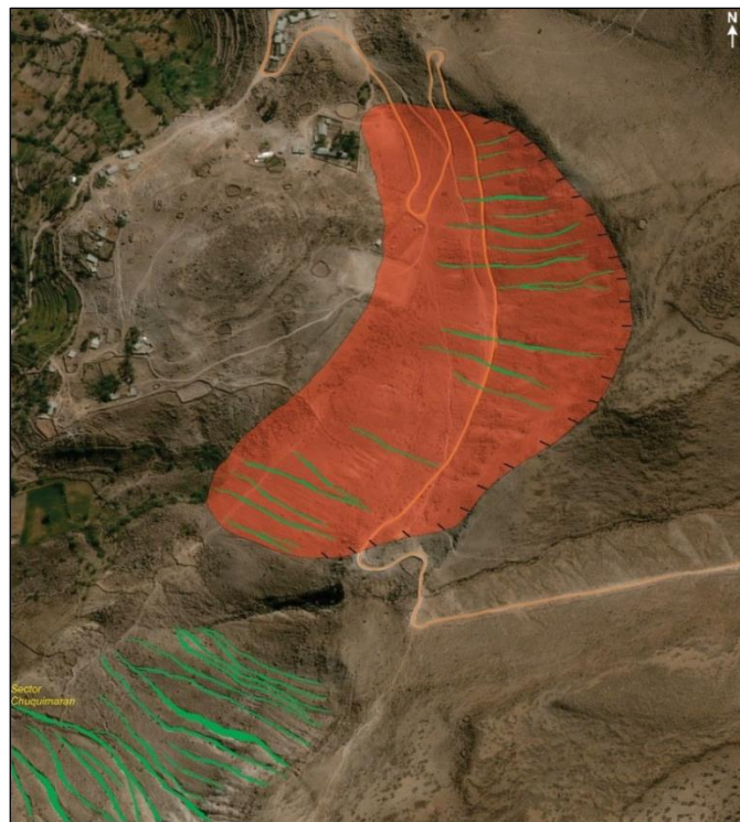
Figura 21. En la imagen se observa derrumbe en la margen izquierda de la quebrada Chuquimaran, en donde también se pudo identificar erosión de ladera (cárcavas).
