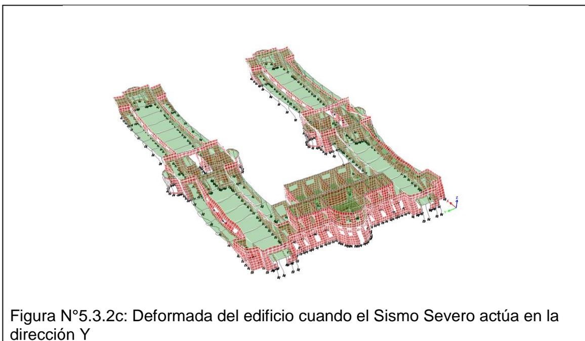
Figura N°5.3.2c: Deformada del edificio cuando el Sismo Severo actúa en la dirección Y
