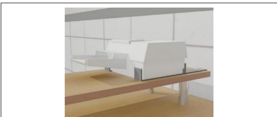
Figura 9.2.3b. Equipos como impresoras deben estar sujetos a asegurados para evitar su desplazamiento ante movimientos sísmicos.
