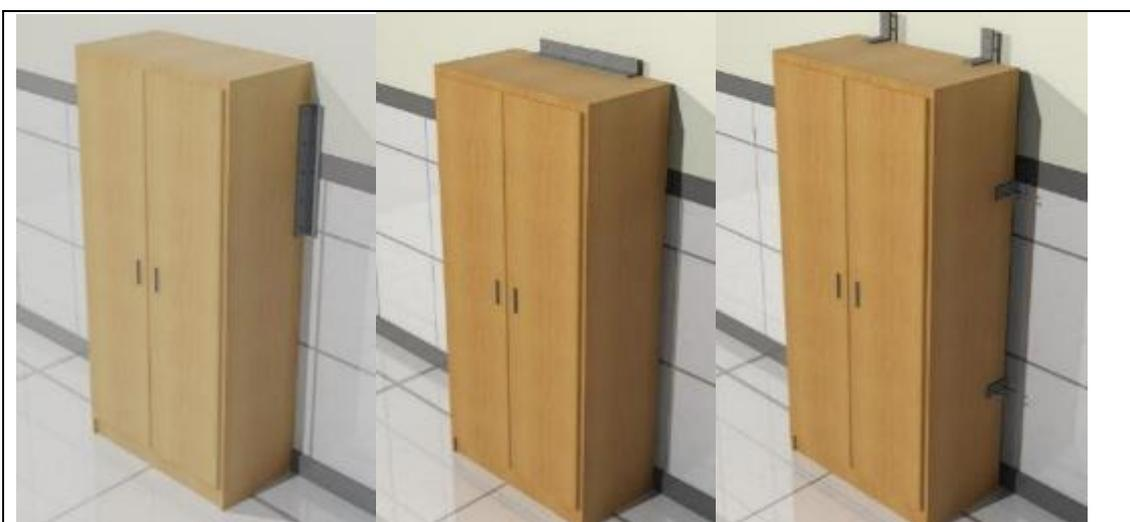
Figura 9.2.3d. Muebles y armarios deben estar fijados y asegurados afín de evitar caídas que afecten al personal de salud o que obstruyan salidas o corredores de evacuación.
