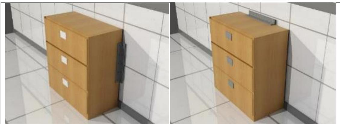
Figura 9.2.3c Archiveros deben estar asegurados y evitar caídas que obstruyan salidas o corredores de evacuación.
