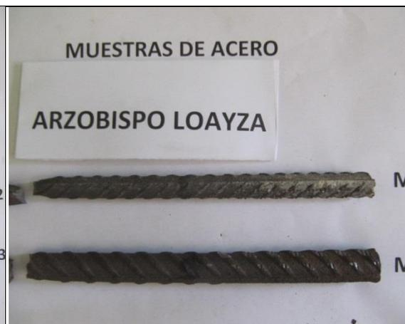
Foto AI-6 Muestras de acero antes y después del ensayo de tracción
