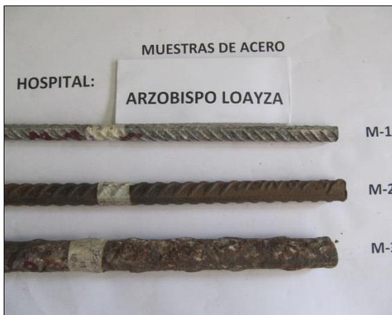
Foto AI-5 Muestras de acero antes y después del ensayo de tracción
