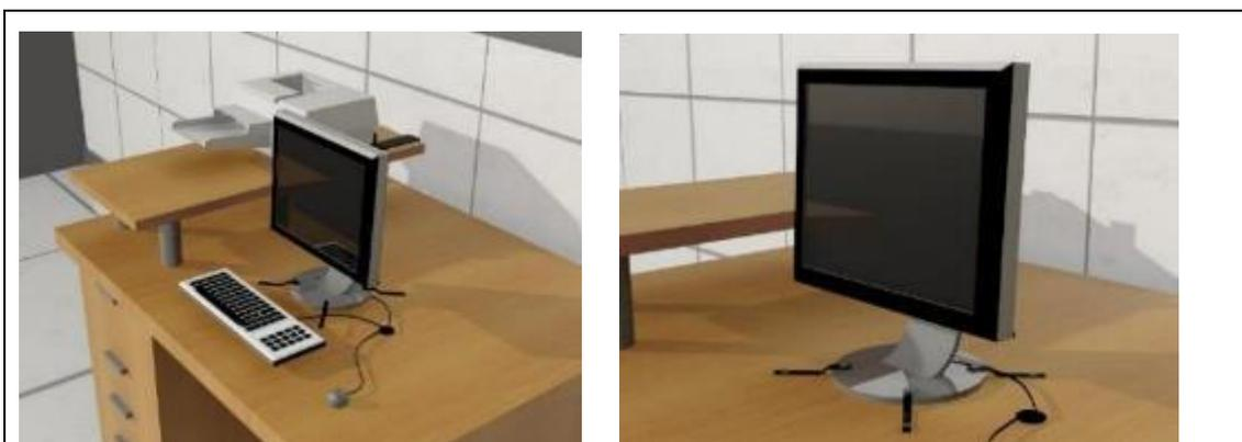
Figura 9.2.3a Monitor fijado con correas al mueble de escritorio y evitar su caída ante movimientos sísmicos.
