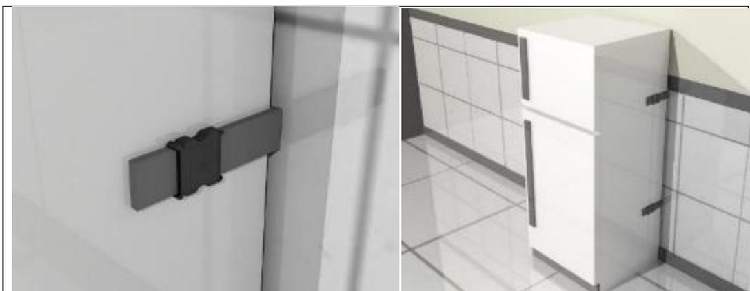
Figura 9.2.4b. Formas de asegurar equipos fijos, mediante seguros de correas a fin de evitar caídas o volcamientos.
