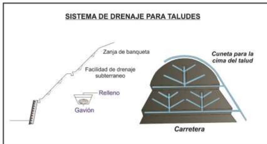
Figura 15. Sistema de drenaje tipo espina de pez.
