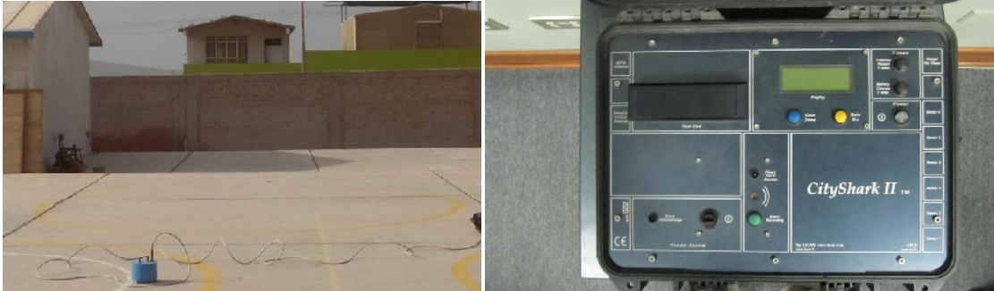
Figura 4: Equipo sísmico utilizado para el registro de vibraciones ambientales: sensores Lennartz (2N) y registrador CitySharp
