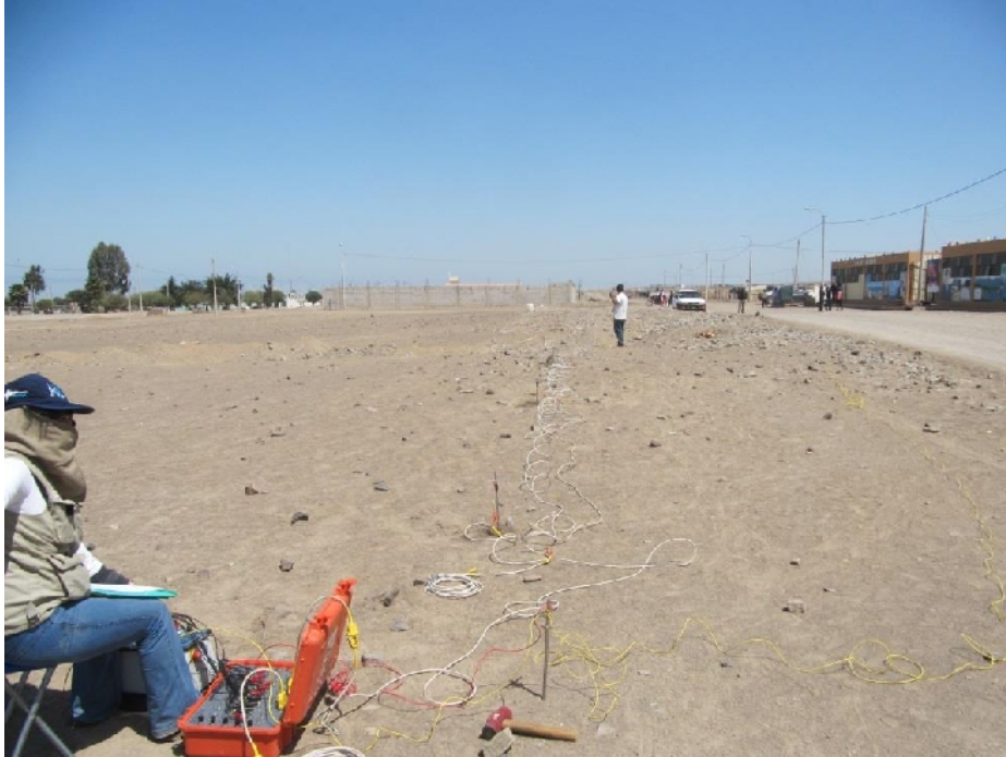
Figura 8: Imagen de disposición del equipo de prospección eléctrica para la toma de datos en la ciudad de Bella Unión
