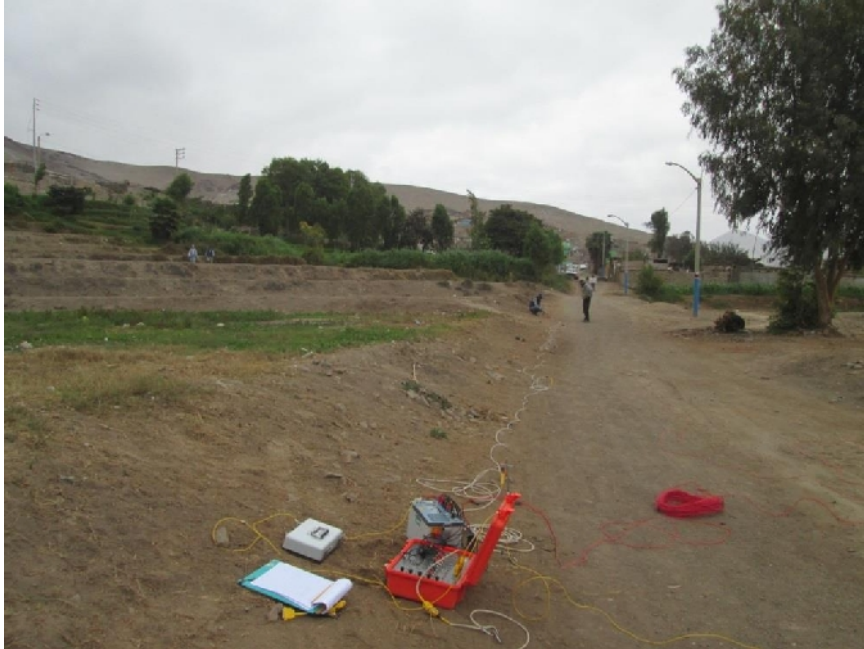
Figura 8: Disposición del equipo de prospección eléctrica en la ciudad de Cochachaca
