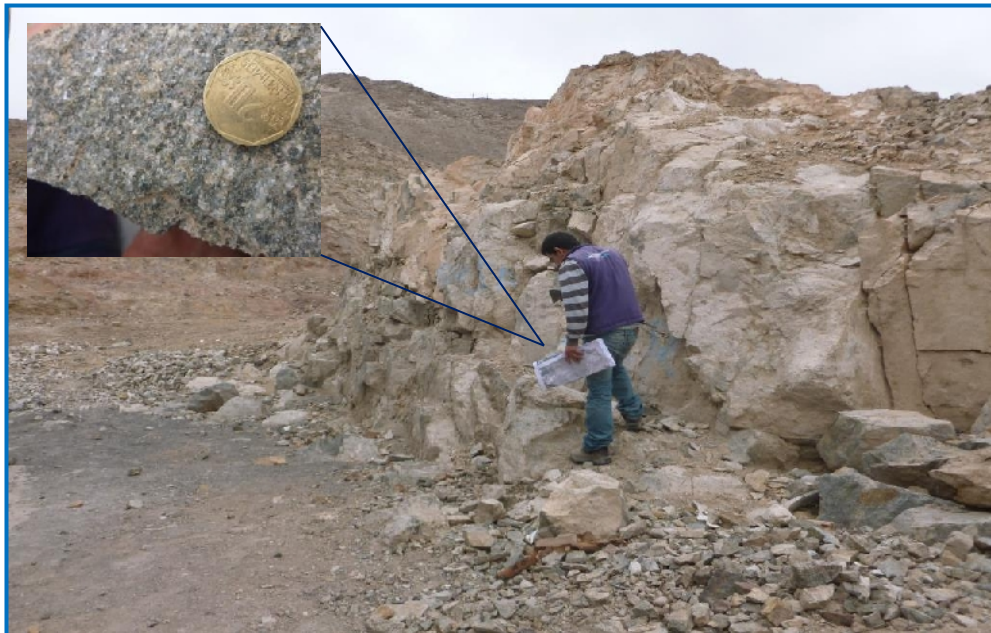
Figura 32: Gneis bandeado que afloran a una distancia de 700 metros al norte de la ciudad de Cochachaca. Este material es usado para cimentaciones de viviendas.
