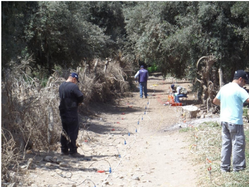
Figura 8: Imagen de la disposición del equipo de refracción sísmica en la ciudad de Yauca
