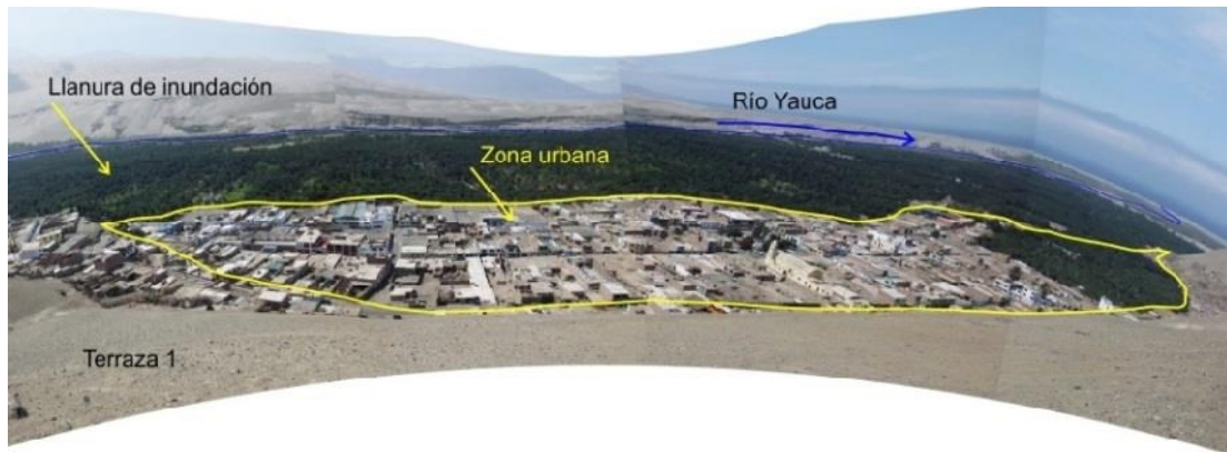
Figura 25: Vista panorámica de Yauca. El 90% del área urbana de la ciudad de encuentra asentada sobre una terraza fluvial antigua.
