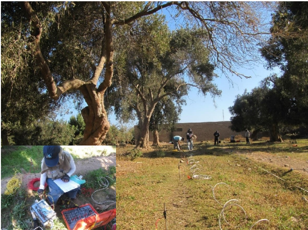
Figura 9: Imagen de disposición del equipo de prospección eléctrica para la toma de datos en la ciudad de Yauca
