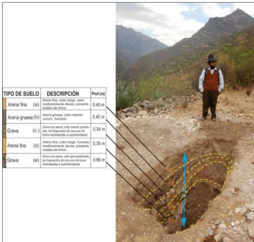
Figura 15. Calicata en terrenos Pillahua, sobre las cuales se identificaron los diferentes niveles de suelo y depositaciones que conforman el subsuelo en el sector Pillahua. Coordenadas UTM 8496155 N, 554418 E, con una altitud 3142.
