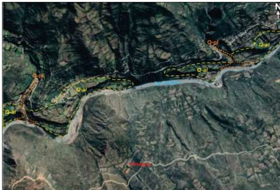
Figura 3. Depósitos proluviales en confluencia con el río Pampas. Frente al centro poblado de Cocas y de la zona propuesta de Pillahua.
