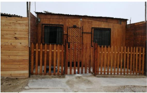
FOTOGRAFÍA N° 12. Mz. U, lote 12 vivienda de material de madera, cimiento de concreto y se encuentra en buen estado.
