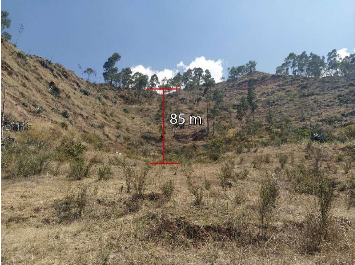
Figura 17. Altura de la escarpa secundaria del deslizamiento antiguo D1, en el sector de Ongoy.
