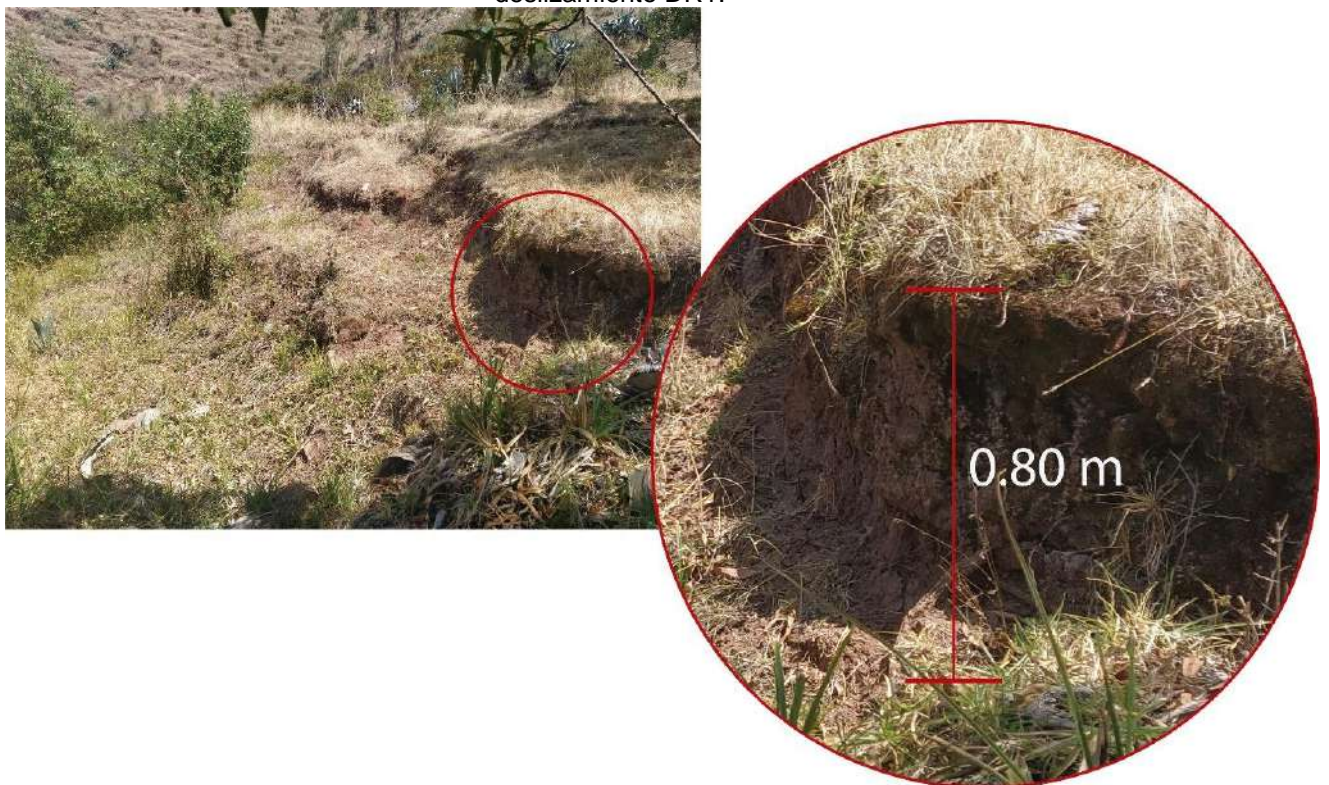
Figura 24. Escapamiento secundario con salto vertical de 0.8 m y longitud de 15 m en el cuerpo del deslizamiento DR1.
