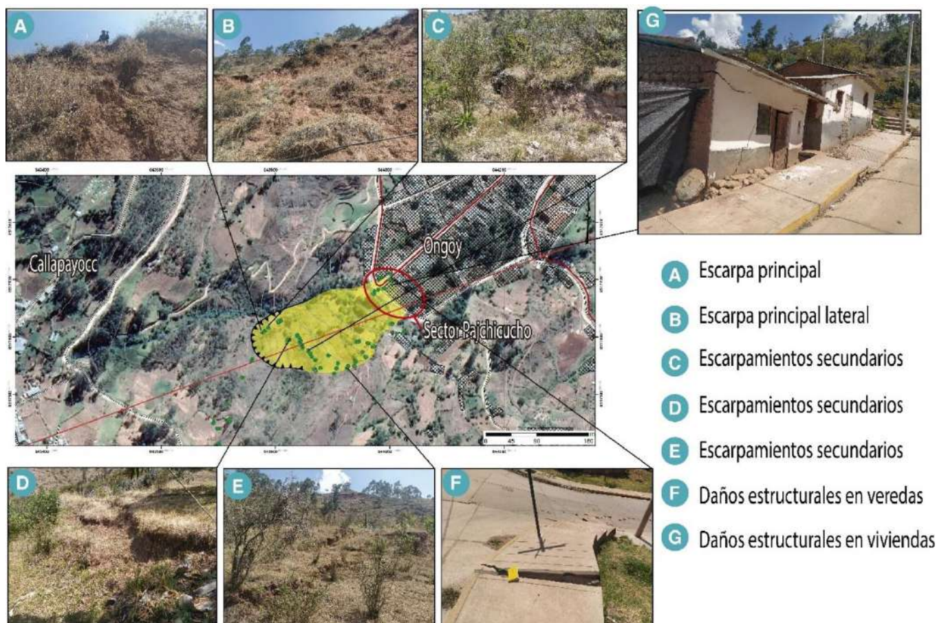
Figura 20. Evidencias de la actividad del deslizamiento DR1.
