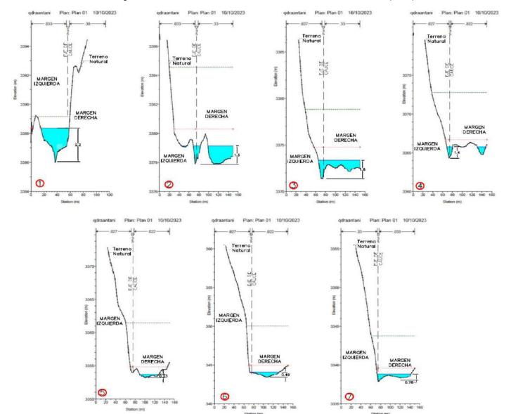
Figura 28. Secciones Transversales de resultados de la simulación (TR50)
