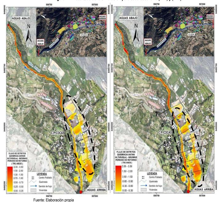
Figura 24. Resultado de la simulación para cada escenario (TR2) y (TR5)
