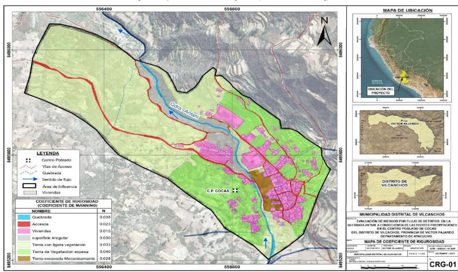
Figura 8. Mapa de Coeficiente de Rugosidad (Coeficiente de Manning)
