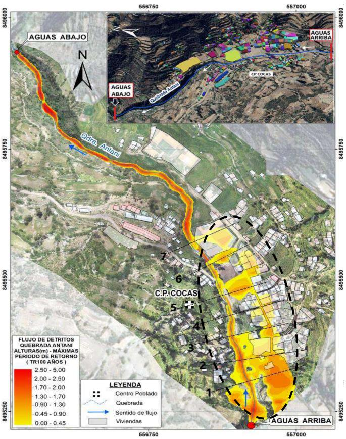
Figura 29. Resultado de la simulación para cada escenario (TR100)
