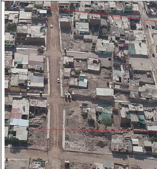
Imagen 67: (A) Se aprecia el estrechamiento de la calle al existir una vivienda que fue un obstaculo para el paso del huico. (B) Vivienda destruida por el flujo de detritos del 07 de febrero del 2019.
