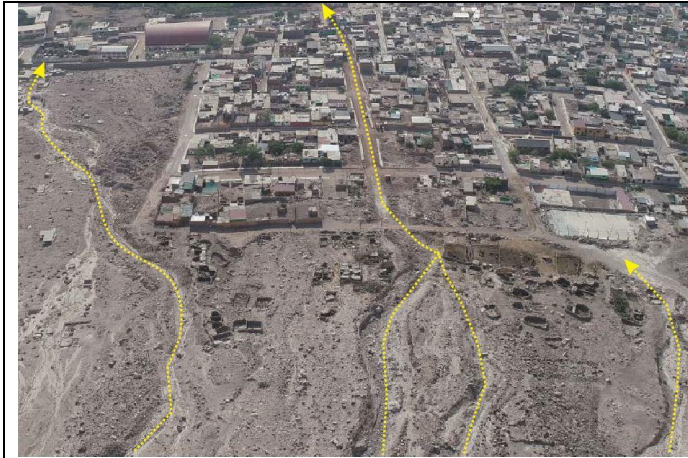
Imagen 65: Se muestra las direcciones que tomaron los flujos de detritos, siendo el evento en la parte central.
