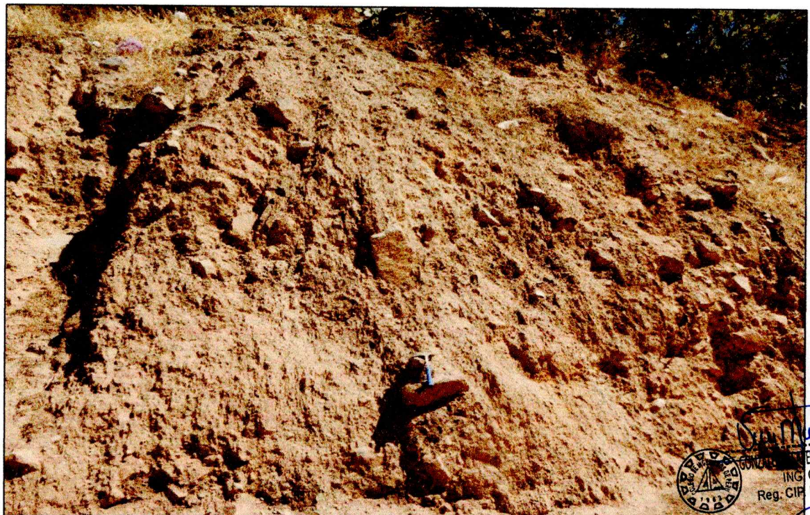
FOTOGRAFIA 03: VISTA DE DEPÓSITO COLUVIO-DELUVIAL (Q-CD), FORMADO POR FRAGMENTOS LÍTICOS, ANGULOSOS A SUBANGULOSOS, HETEROMÉTRICOS DE HASTA 0.48 M DE DIÁMETRO, ENVUELTOS EN MATRIZ ARCILLOSO -LIMO ARENOSO. COORDENADAS REFERENCIALES UTM WGS-84, 18S: E: 500200; N: 8618163
