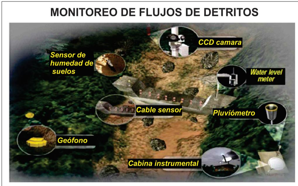
Figura 8.21 Sensores utilizados para el monitoreo de flujos de detritos (Fotografía tomada de Soil and Water Conservation Bureau SWCB-Taiwan por Vilchez, 2010).
