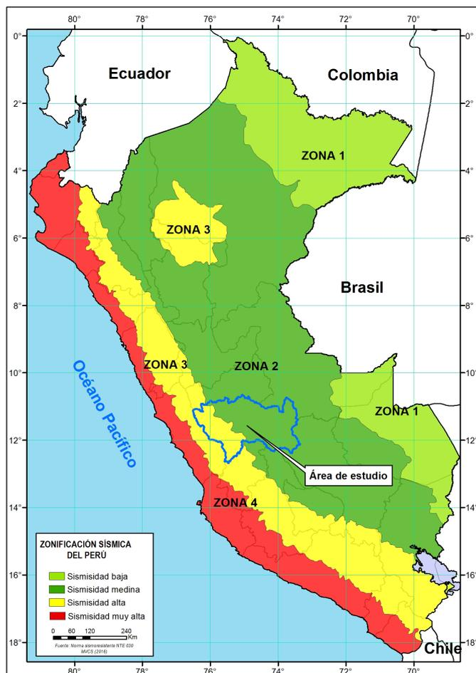
Figura 6.17 Zonificación Sísmica del Perú.
