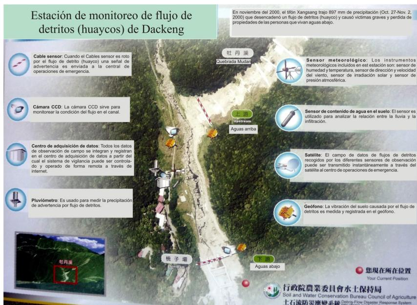
Figura 8.22 Estación de monitoreo de flujo de detritos (Fotografía tomada de Soil and Water Conservation Bureau SWCB-Taiwan por Vilchez, 2010).
