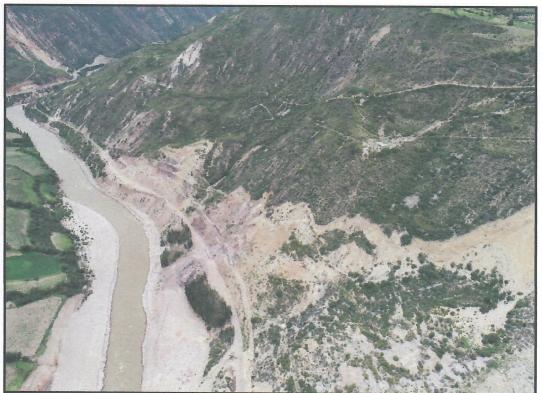
Imagen 18: fotografía aérea (Drone), Vista del Deslizamiento ocurrido años atrás y colapso de la vía férrea.
