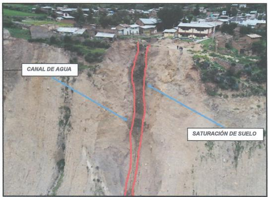
**Imagen 06**: fotografía aérea (Drone) Zocavamiento en forma de canales causado por aguas pluviales y residuales.
