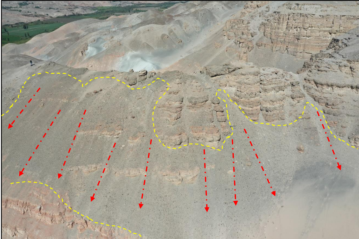
Figura 5. Acumulación de detritos adosados en las laderas de las colinas y lomadas al norte del sector Taca, susceptibles de ser removidos como avalanchas de detritos con lluvias.
