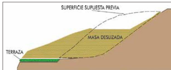
FIGURA N° 06.- DETALLE DE MASA DESLIZADA.
