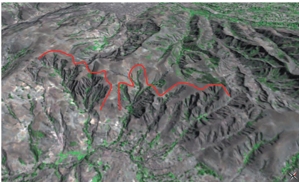
Imagen 37 Margen derecha de la quebrada Pariac (cerro Varincagirca) se aprecia el grado de erosión por cárcavas en la zona que origina flujos de detritos en la temporada de lluvias.
