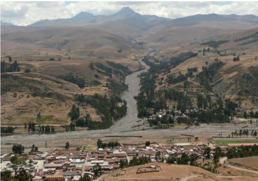
Fotografía 84 Vista del valle fluvio-glaciar de Atoc Huaranca y parte de la ciudad de Recuay. Nótese las barreras construidas para cambiar el rumbo de los flujos de detritos y que no impacten directamente sobre la ciudad de Recuay.
