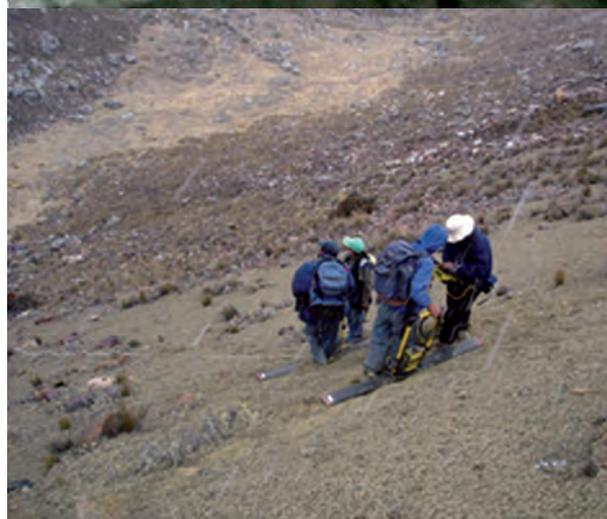
Figura 3: Prospección geofísica; en la morrena lateral izquierda se observa dos líneas transmisoras en forma paralela.
