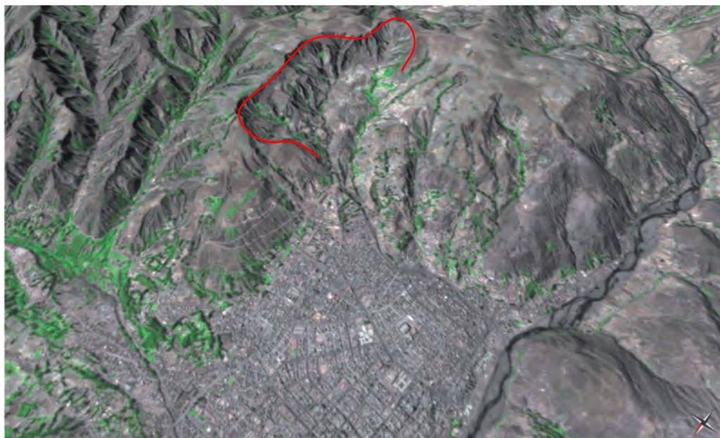
Imagen 38 Vista satelital 3D que muestra la escarpa del deslizamiento y cárcavas de Rataquenua y Cruzpunta y como la población se ubica directamente debajo de la zona de erosión.
