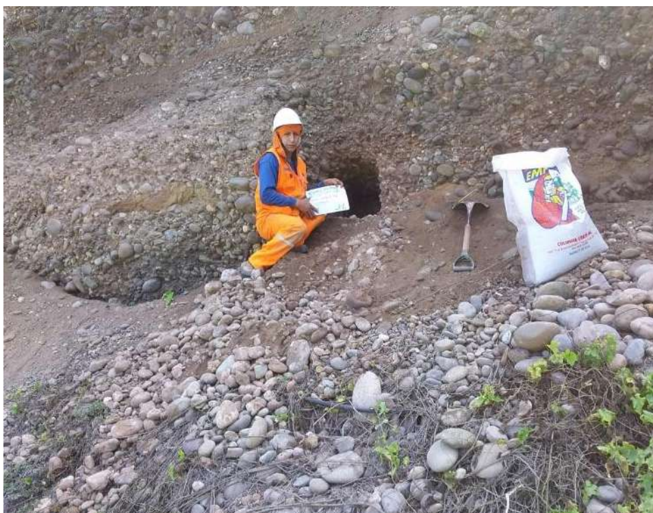
Figura 31. Calicata #14, realiza en parte inferior del acantilado
