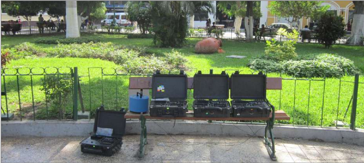
Figura 3. Equipo sísmico utilizado para el registro de vibraciones ambientales en el distrito de Miraflores: sensor Lennartz (2N) y registradores CityShark II
