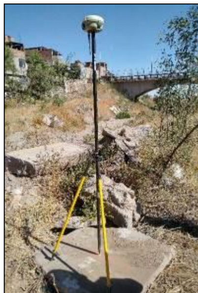
Figura 7 Toma de puntos de control en la quebrada San Lázaro, para un futuro sobrevuelo de dron.
